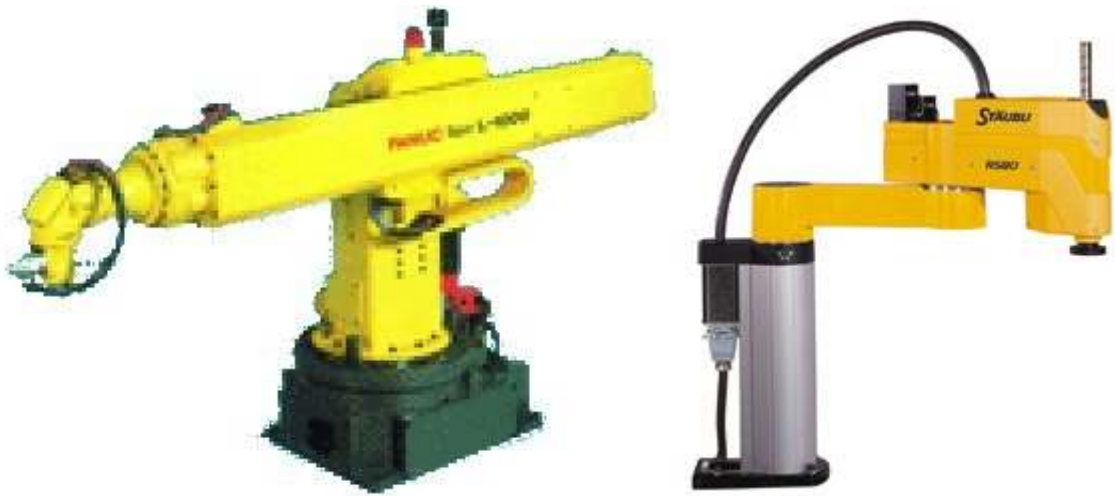
Figura 3.19 – Braço do tipo polar, feito pela Fanuc, à esquerda e um robô SCARA, produzido pela Stäubli, à direita.
